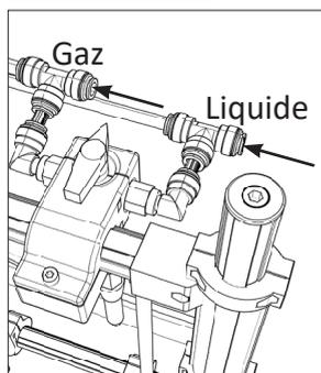
H. Connectez les tuyaux gaz et liquide en suivant les indications fléchées
